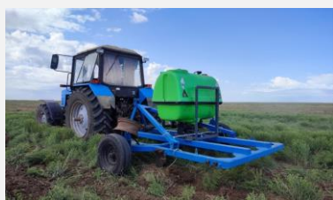
Рисунок 5 - 3-х ярусный культиватор-плоскорез для борьбы с горчаком ползучим
